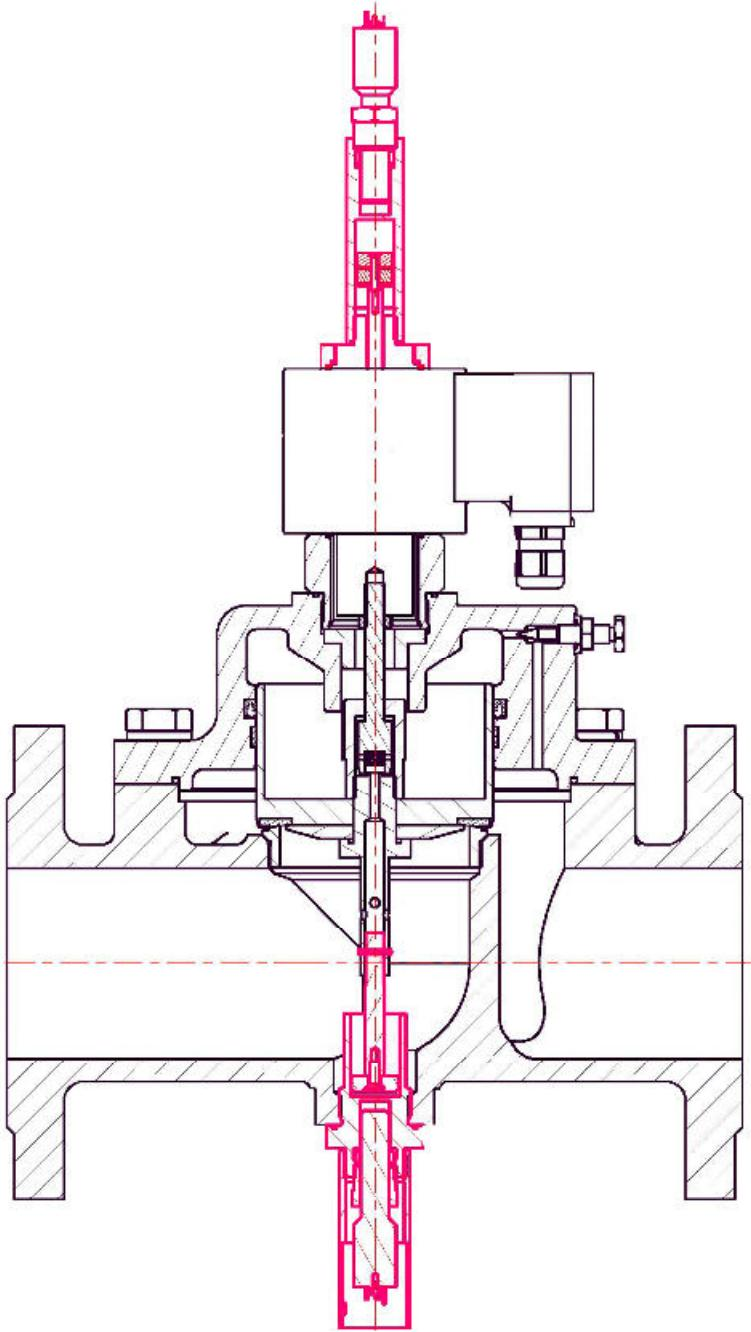
**EJ – Два индикатора положения (два выключателя)**
